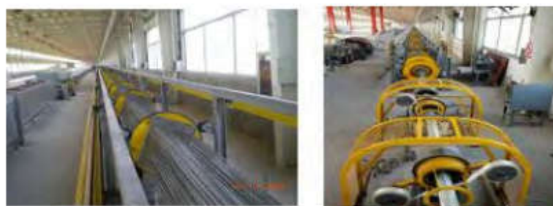
图 2 斜拉索扭绞成型
