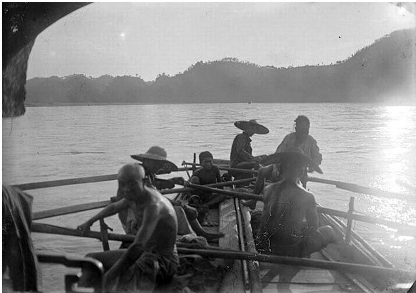
★ 停桡放流（注意图中的桡和插在船舷上的桨脚）
