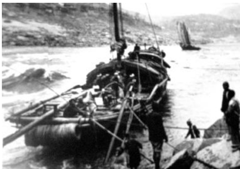
★ 槽船（艄在正中，伸出船头；槽架在两侧船舷上）
