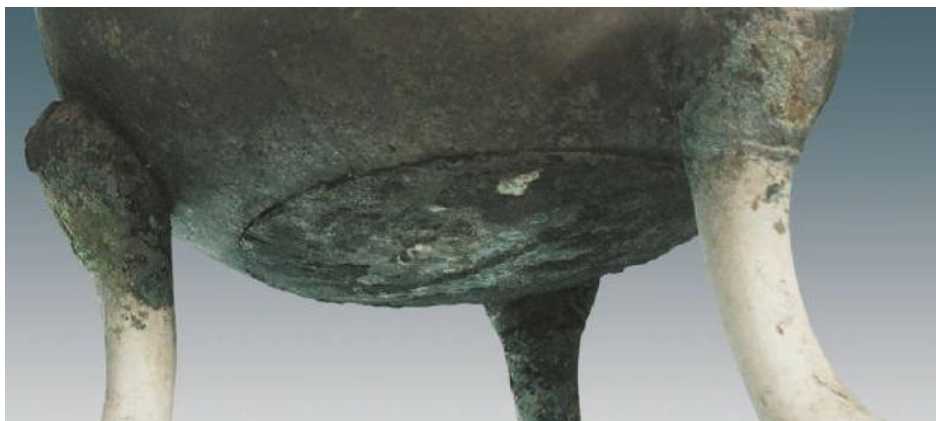
图八，2 绍兴306墓铜鼎底部范线与浇铸痕迹
