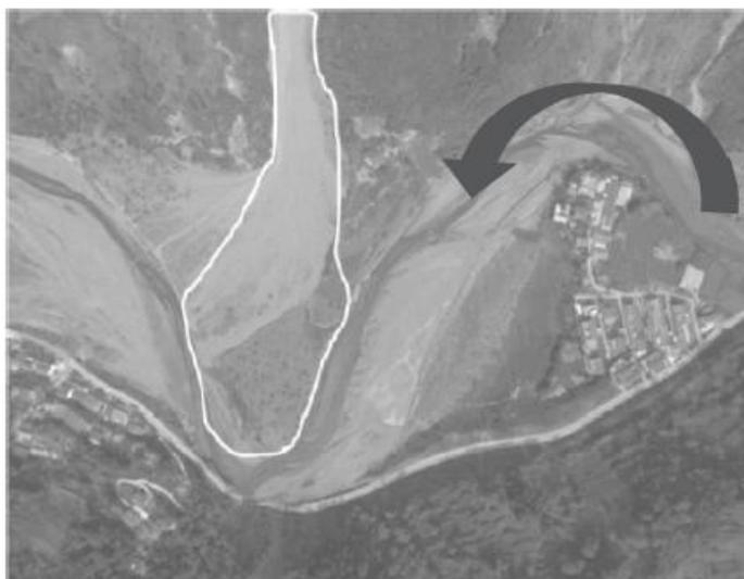
图9 南坝窖子沟堆积扇灾损土地(无人机拍摄)
