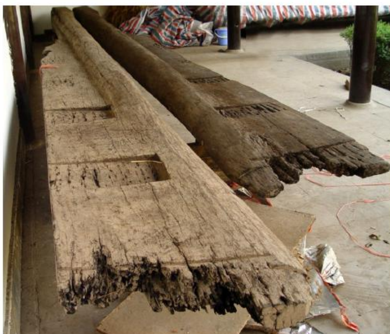
图一// 宝船厂遗址六作塘出土两根成品舵杆 (左侧为BZ6:702,右侧为BZ6:701)
