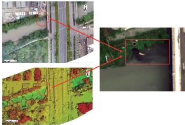
图3 某地黑臭河流无人机遥感调查排污口正射与影像图
