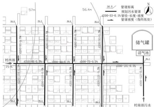
图5 该村东北部污水管网规划局部示意图
