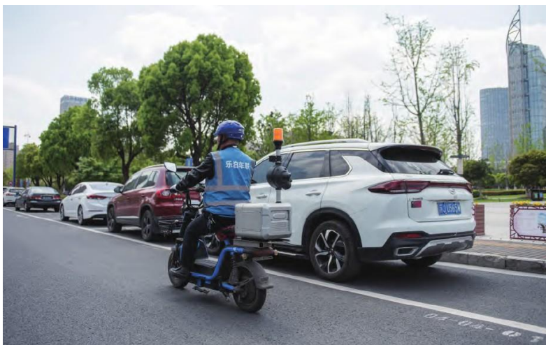
右图苏州市吴江区城管局采用智能化巡检管理，依托北斗系统高精度定位+智能 AI 识别技术，实现路内泊位“先离场后付费”管理摄影吴江区城管局
