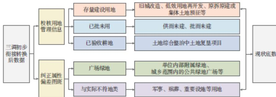
图5 三调地类初步衔接转换后属性核对逻辑流程
